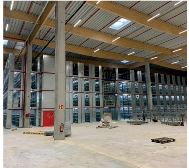
Mehrgeschossregalanlage mit 25.000 Pickplätzen.
