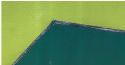
Alle PVC-Folien haben ein „Gedächtnis“. Hier haben die einzelnen Bestandteile versucht, im Laufe der Zeit wieder in ihre alte Form zurückzukehren. Die Folge: Die Grafik ist geschrumpft, zurück blieb der Klebstoff, der Schmutz anzog und so den schwarzen Streifen verursachte.
