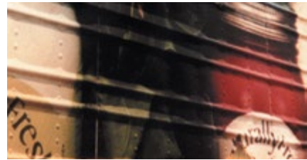
Der Einsatz von Tinten und Folien unterschiedlicher Hersteller steigert das Risiko, dass die Komponenten miteinander reagieren – mit unvorhersehbaren Ergebnissen. Hier sind die Druckfarben ineinander gelaufen.
