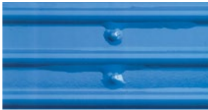
Ein häufiges Problem: Folie rund um Nieten und Vertiefungen löst sich ab. Als Ursache gilt allgemein die beschränkte Dehnbarkeit der Folie und schlechte Klebkraft.
